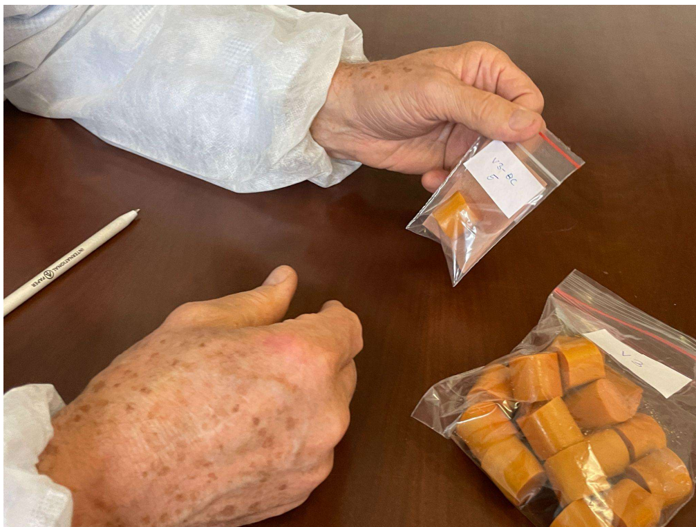
7. fotó: Mintaelőkészítés - a cellulóz alapú, aktív hatóanyagot tartalmazó prototípusból készült csomagolás hatásának húsipari termék minőségmegőrzési/fogyaszthatósági idejére.
