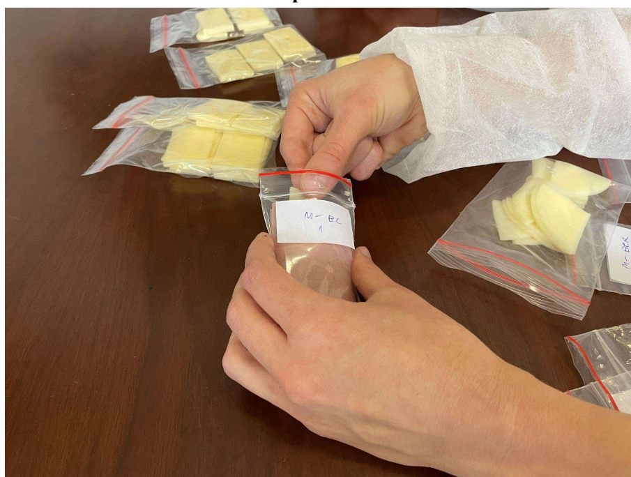
10. fotó: Mintaelőkészítés - a cellulóz alapú, aktív hatóanyagot tartalmazó prototípusból készült csomagolás hatásának sajtermékek minőségmegőrzési/fogyaszthatósági idejére.
