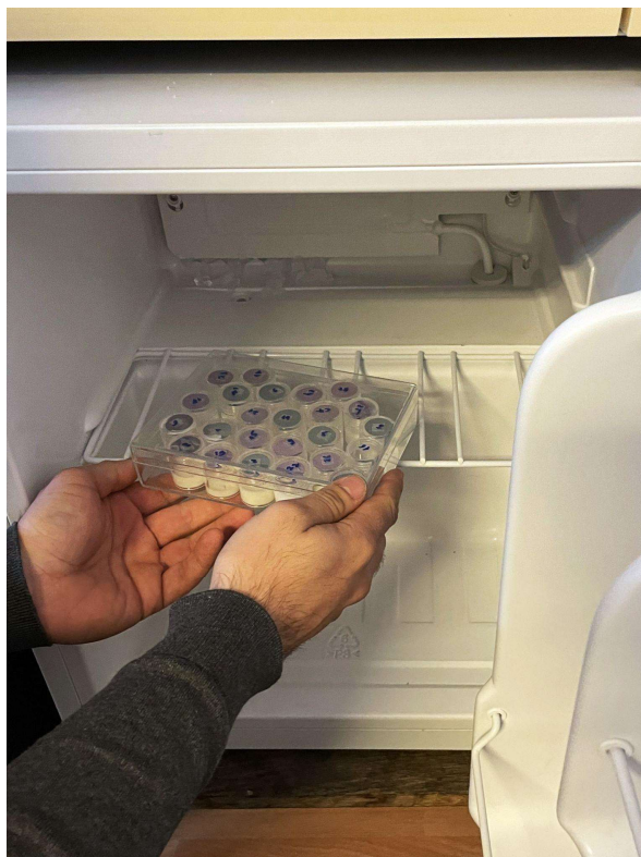
6. fotó: Vizsgálat - tejek romlásának, cellulóz alapú, rezponzív anyagot tartalmazó prototípussal való jelezhetősége
