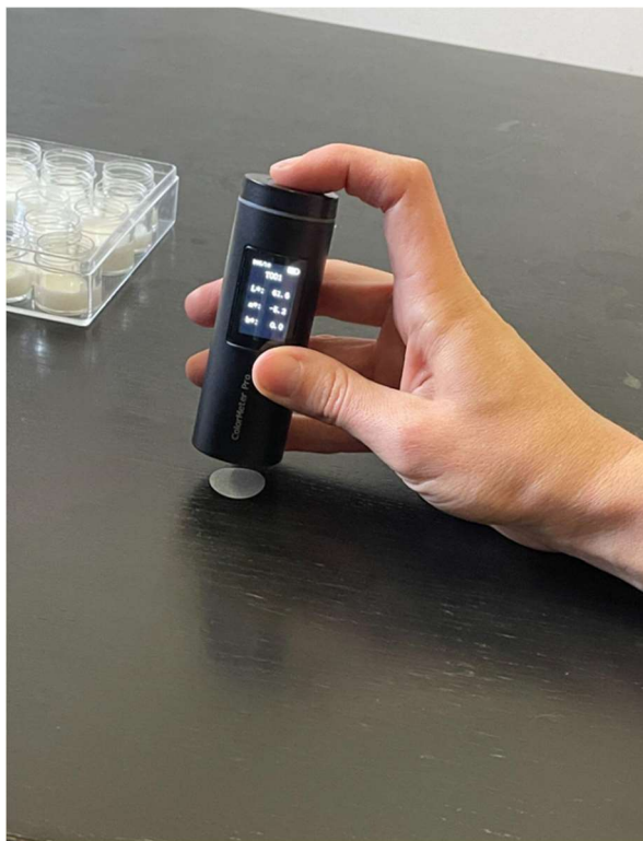
5. fotó: Színmérés - tejek romlásának, cellulóz alapú, rezponzív anyagot tartalmazó prototípussal való jelezhetőségének vizsgálatához
