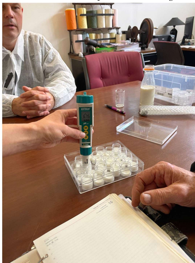
2. fotó: pH mérés - tejek romlásának vizsgálata
