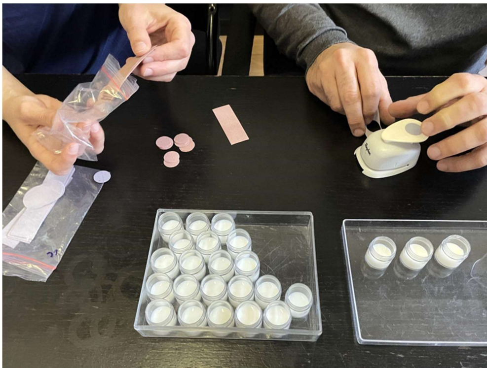
3. fotó: Mintaelőkészítés - tejek romlásának, cellulóz alapú, rezponzív anyagot tartalmazó prototípussal való jelezhetőségének vizsgálatához
