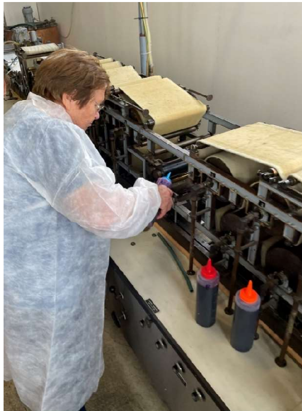
6. fotó: Papírgyártás – felületi bevonáselőkészítése
