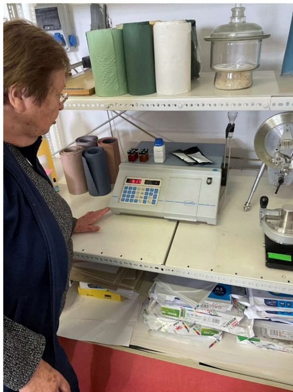
10. fotó: Spektrofotométer mérés közben - DPPH
