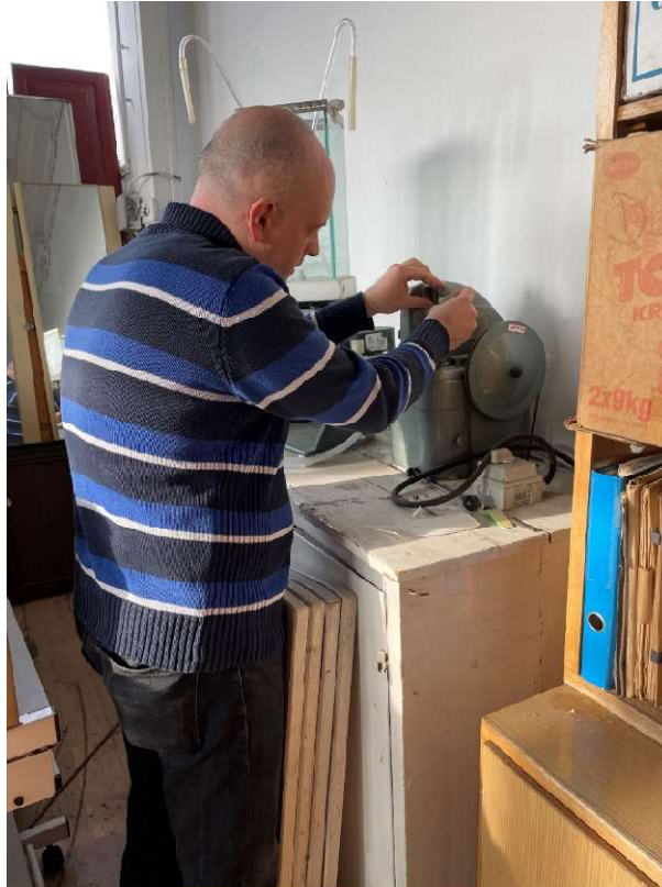
13. fotó: A minták kettőshajtógatással szembeni ellenállásának vizsgálata
