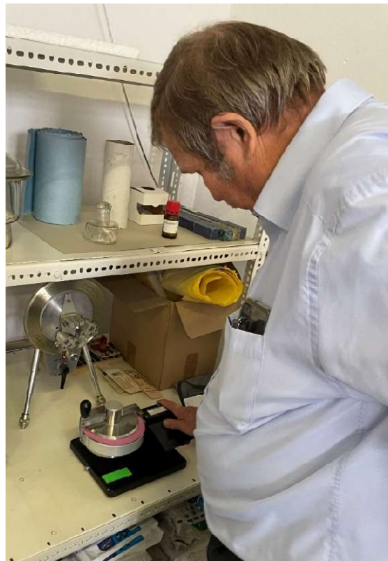
12. fotó: A minták vízábszorpciójának mérése (COBB)
