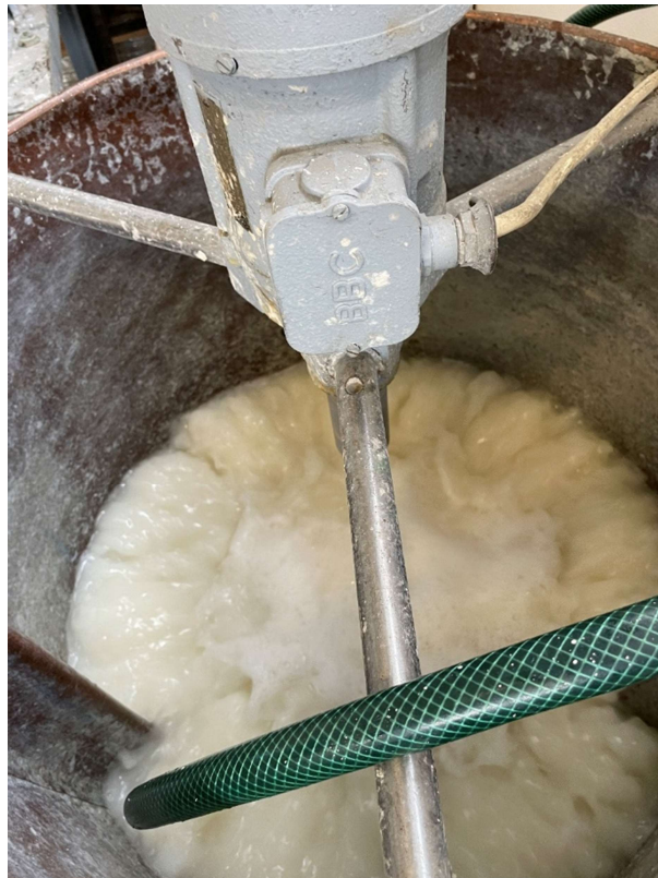
2. fotó: A cellulóz rost papírgyártásra való előkészítése
