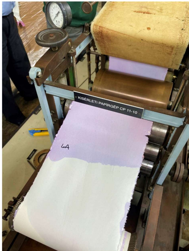
8. fotó: A bevonattal ellátott papír gyártásának befejező műveletei (szárítás, tekerceselés)
