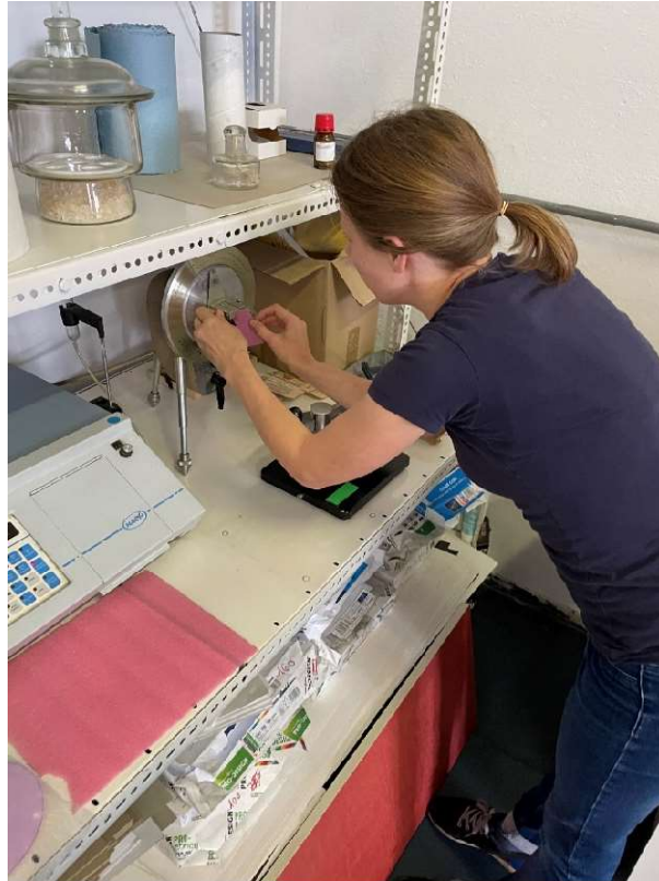
11. fotó: A minták merevségének mérése
