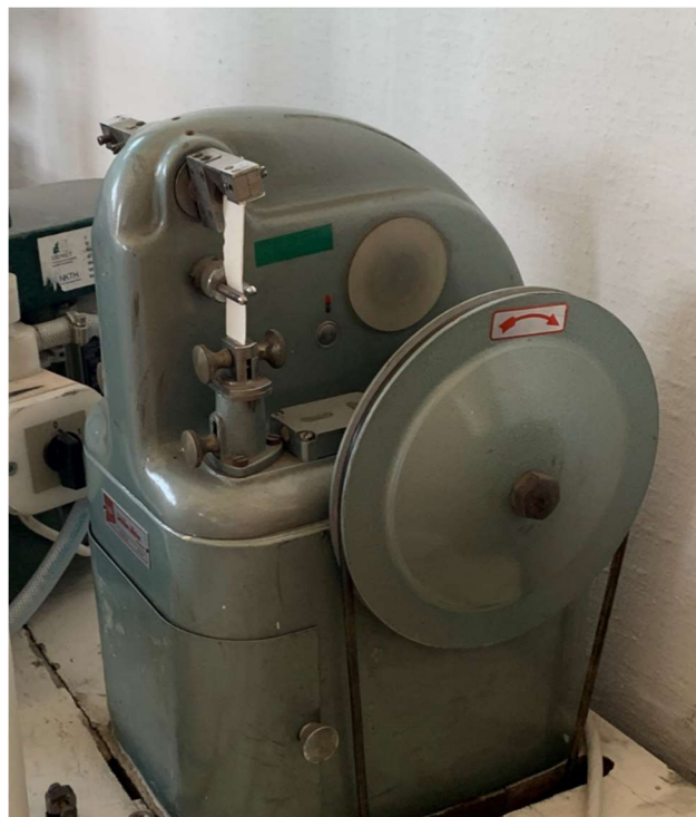
14. fotó: Hajtogatási ellenállás vizsgálat
